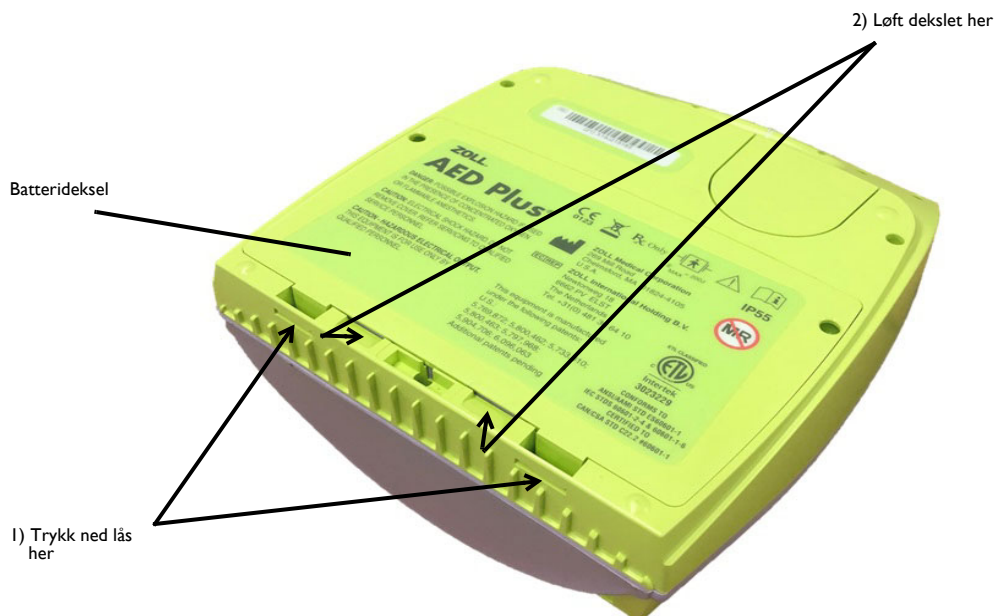
Figur 7: Fjerne batteridekslet
